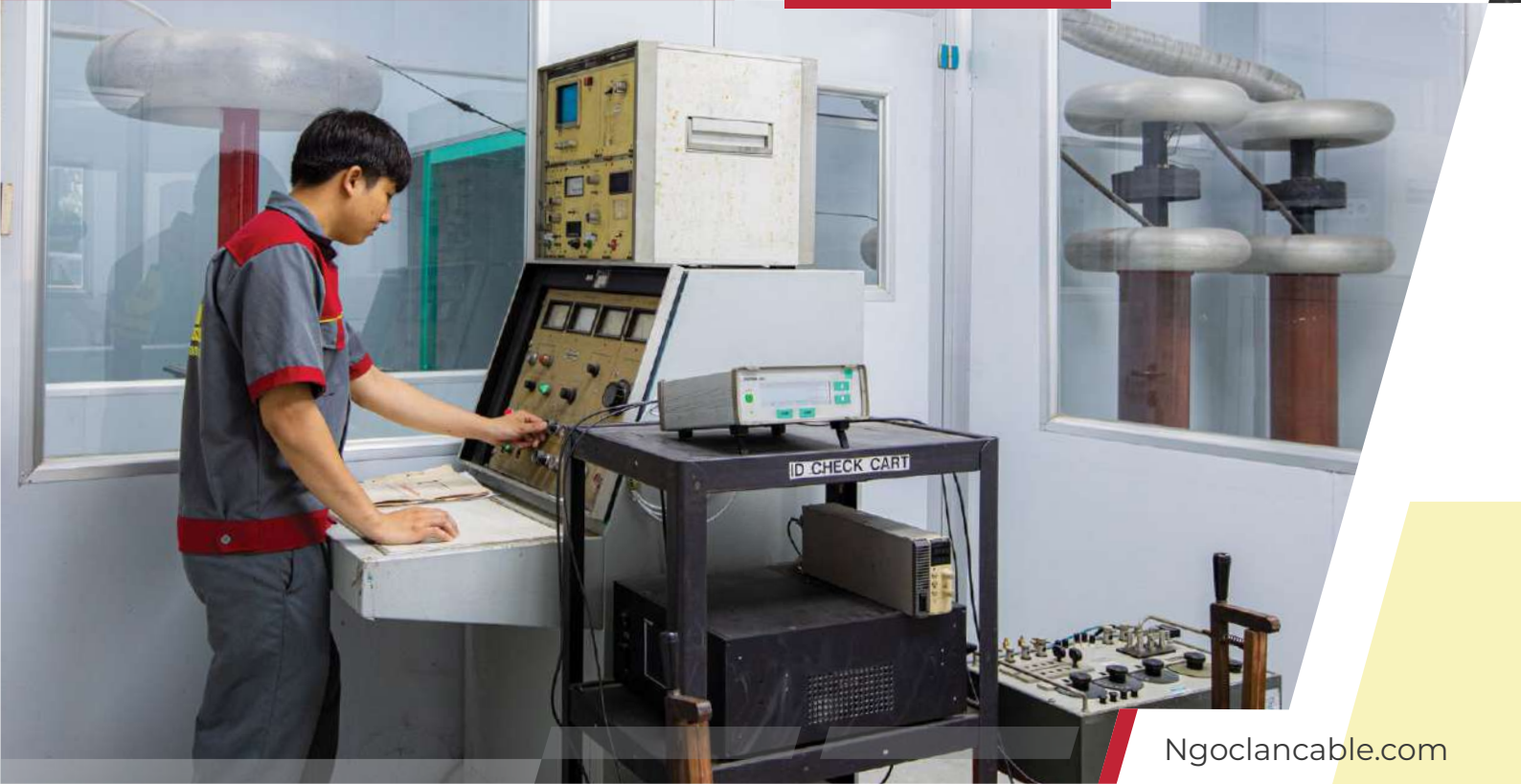
Phòng thử cao áp Hipotronics 250kV-2500kVA. 50/60Hz
